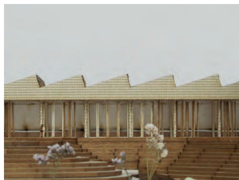
Des panneaux en polycarbonate accordéon ouvrant sur le paysage - Maquette au 1/200
