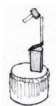
Fendage de tavaillon (scandula en corse) et pose en superposition
