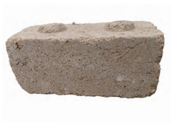
La terre comme matériau - Brique de terre crue compressée
