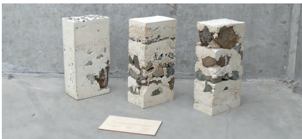
Le béton cyclopéen, une matière ancrée - Echantillons de matière
