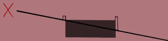
Muret trop haut pour l'implantation de la piscine
