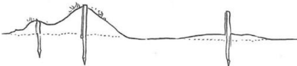
Installation de Ganivelles à Banda Bianca
